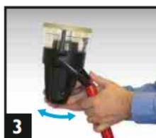
3 Ajuste el ángulo del comprobador con la palanquita inferior y colóquelo sobre el detector.
